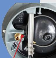
Dichtung: automatisches Abdichten auf dem Kugelflansch beim Aufsetzen der Beckenschale auf das Unterteil
